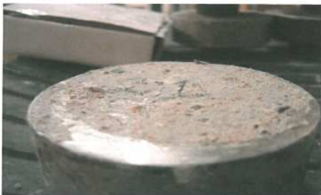
Foto 8 Dragklacka 2.1 : Svag vidhäftning mellan översta betongskikten
