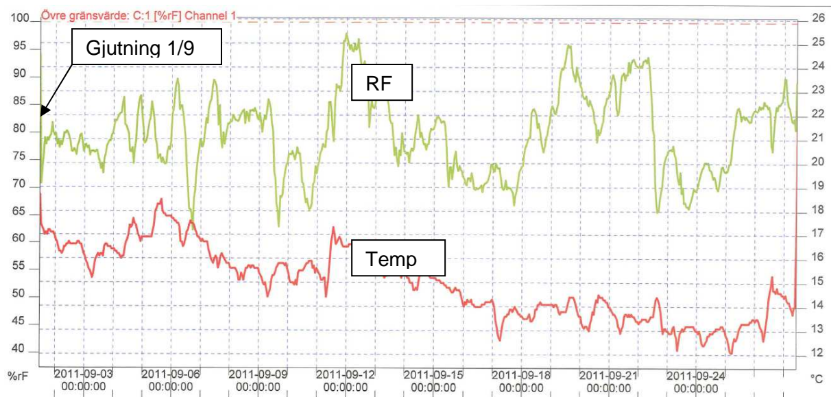
Figur 4 – Luftens RF och temperatur följdes upp i anslutning till pågjutning av plan 1 från gjutningstidpunkten och ca 3 veckor framåt.
